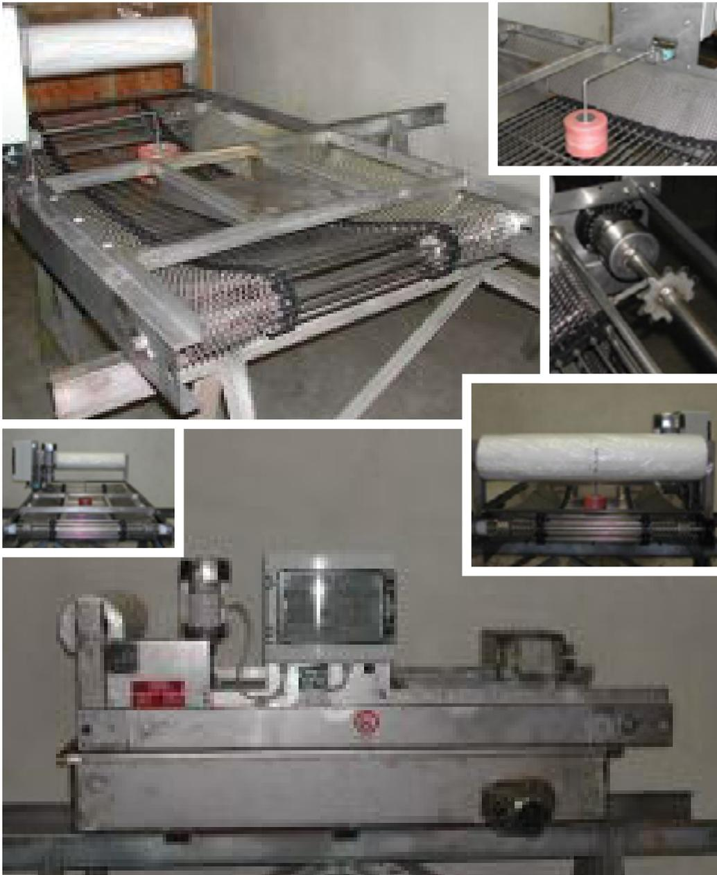
Macchina che consente per semplice gravità, attraverso un tessuto-non-tessuto, la filtrazione di lubrorefrigeranti con un grado di filtraggio anche molto elevato.
