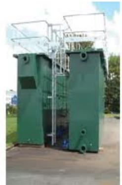
Séparateur complet avec réservoir et packs lamellaires.
